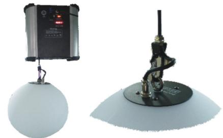
Den Karabiner in die Öse am LED-Ball einhängen und das Datenkabel in die 4-polige Buchse stecken. Dabei den Stecker mit dem Sicherungsring verriegeln.
