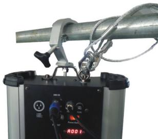
Die Montageklammer und das Fangseil an der Traverse befestigen. Für eine ausreichende Luftzirkulation 50 cm Abstand zu angrenzenden Flächen einhalten und die Lüftungsöffnungen am Gehäuse nicht abdecken.
