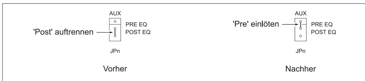
Abb. 12.1: Aux Send > Pre-EQ-Modifikation in den Kanälen 1 bis 24
