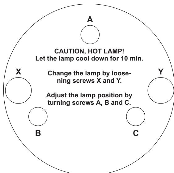
El sistema de portalámparas está ajustado en la fábrica. Como las lámparas de los fabricantes diferentes son diferentes, puede ser necesario de reajustar la posición del sistema de portalámparas.
