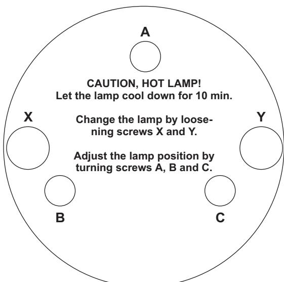
Le porte-lampe de l'appareil est ajusté à l'usine. Comme les lampes à utiliser diffèrent d'un fabricant à l'autre, il pourrait devenir nécessaire de procéder à un nouveau ajustage de la position du porte-lampe.
